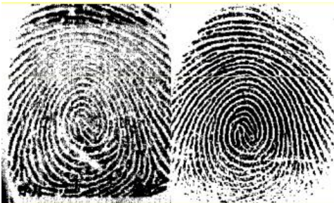
Oklamání senzoru Suprema SFM 3020 (optický senzor) pomocí razítka
